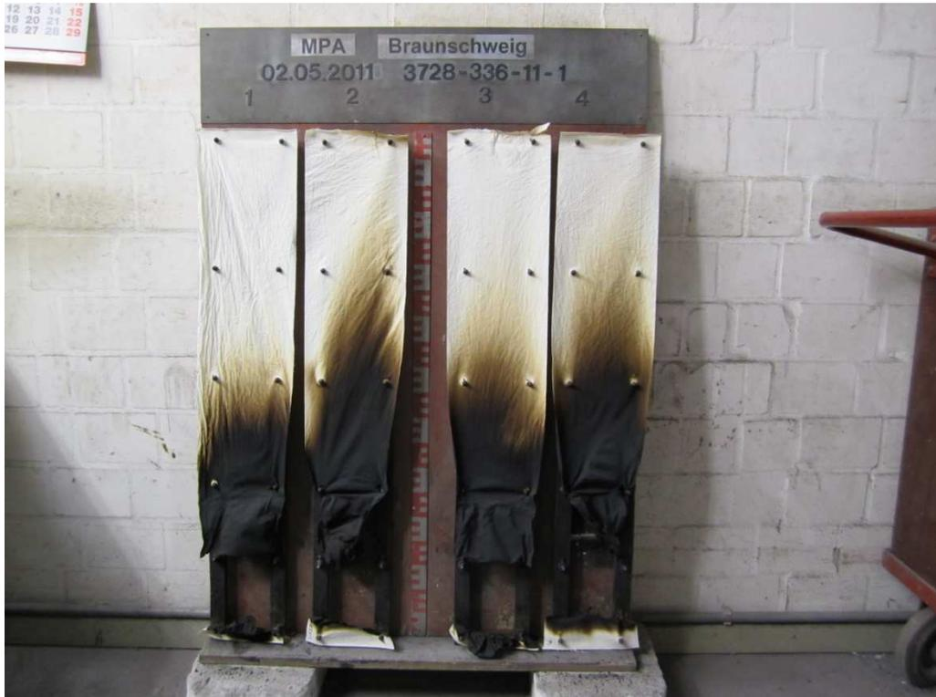
Ansicht der Prüfkörper (Baumwollgebe 137 g/m<sup>2</sup> mit Flammschutzmittel „KAPPAFLAM CFP“ nach der Brandschachtprüfung
