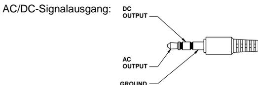
AC: Ausgangsspannung: 1Vrms entsprechend jedem Bereichsschritt.
