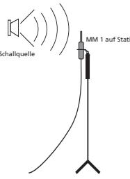
Das MM 1 kann an jeden Mikrofoneingang mit einer Phantomspeisung zwischen 12 - 48 V angeschlossen werden. Zum Anschluss dient ein Standard-XLR-Kabel.
