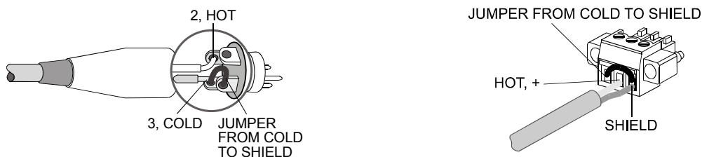
Illustration 2.11 : Connexion non-symétrisée de l'entrée
